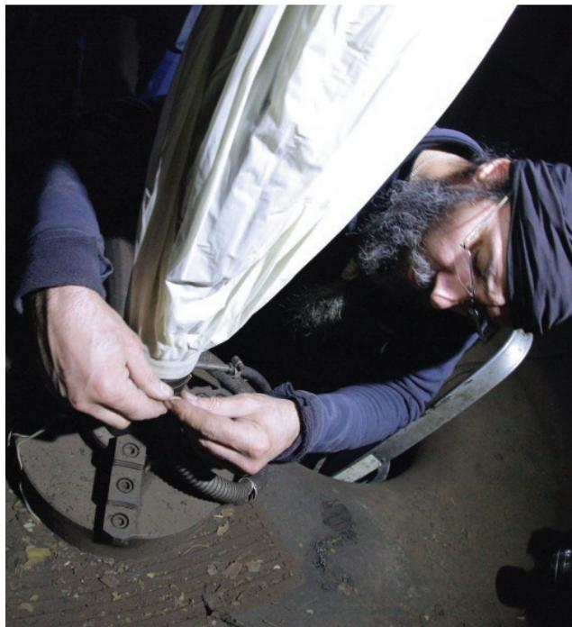
Заместитель заведующего лабораторией 1.1.1 отдела ударно-волновых воздействий О.И. Солнцев показывает приборы, которые фиксируют все необходимые параметры взрыва (слева вверху); механик высшей квалификации А.М. Морев завершает установку оболочки для газовой смеси внутри камеры (вверху)
