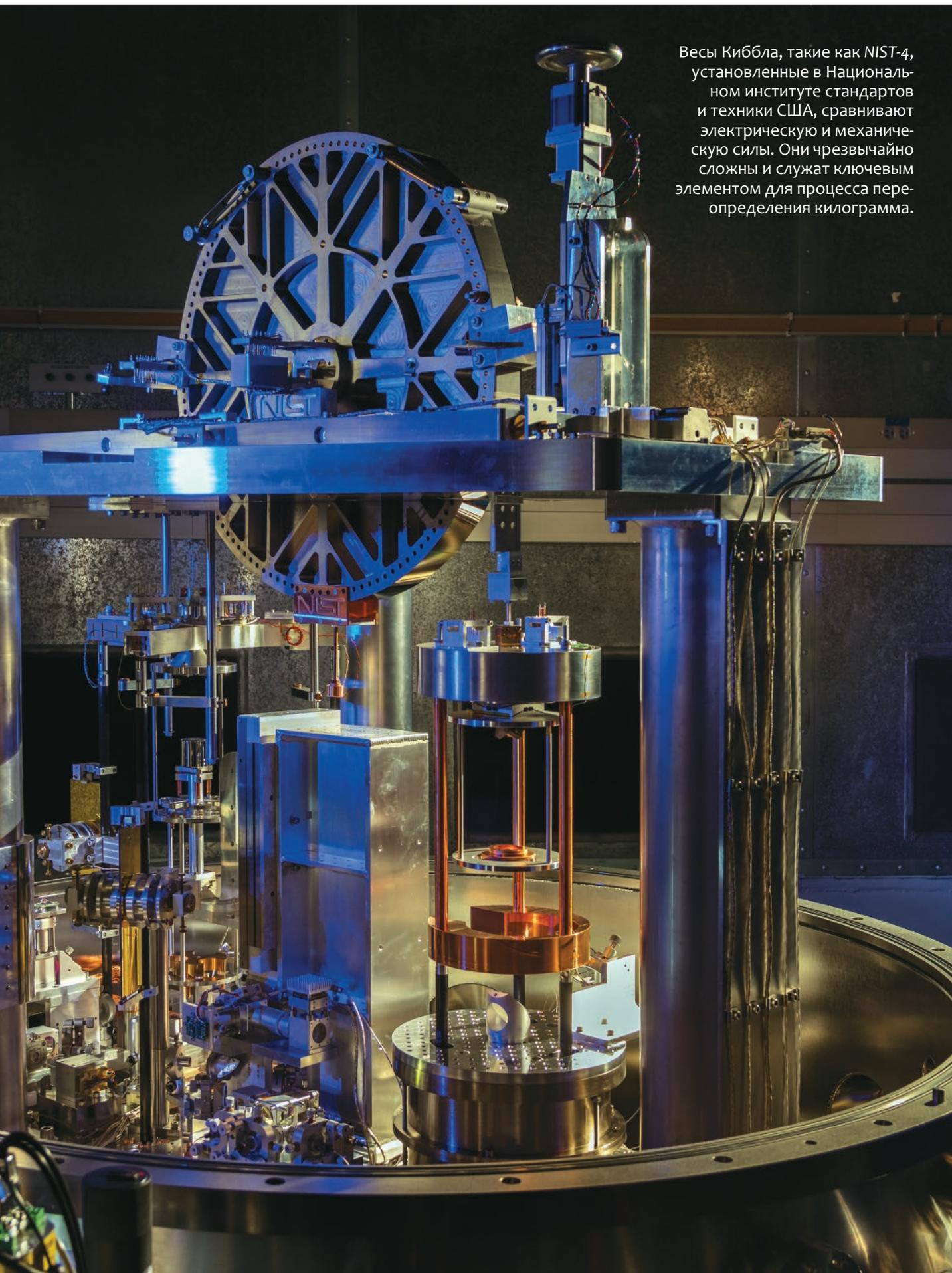
Весы Киббла, такие как NIST-4, установленные в Национальном институте стандартов и техники США, сравнивают электрическую и механическую силы. Они чрезвычайно сложны и служат ключевым элементом для процесса перепределения килограмма.
